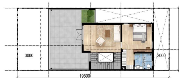
MẶT BẰNG TẦNG 3 Diện tích sàn xây dựng : 51.5 m 2 Diện tích ban công : 39.7 m 2
